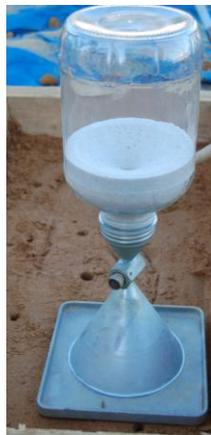
**Figure 2.3 Sand Cone apparatus**
